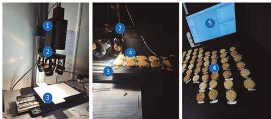
Figura 3. Configuración del equipo empleado para la captura de imágenes de pan mediante la técnica HSI: (1) Cámara hiperspectral Resonon Pika-L; (2) Lámparas halógenas; (3) Plataforma móvil; (4) muestras de pan; (5) Ordenador.
